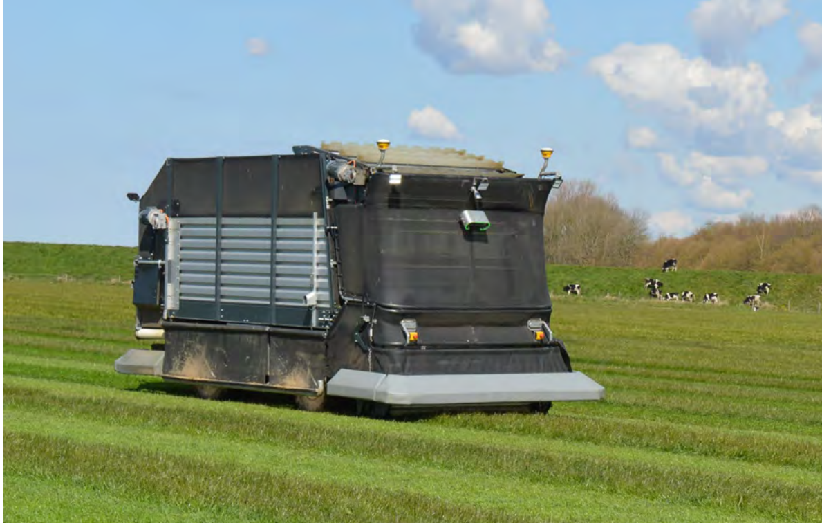
De Lely autonome maairobot maait vers gras en brengt het direct bij de koeien in de stal.
